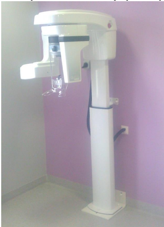
Rysunek 6 Urządzenie zamontowane na płycie montażowej
