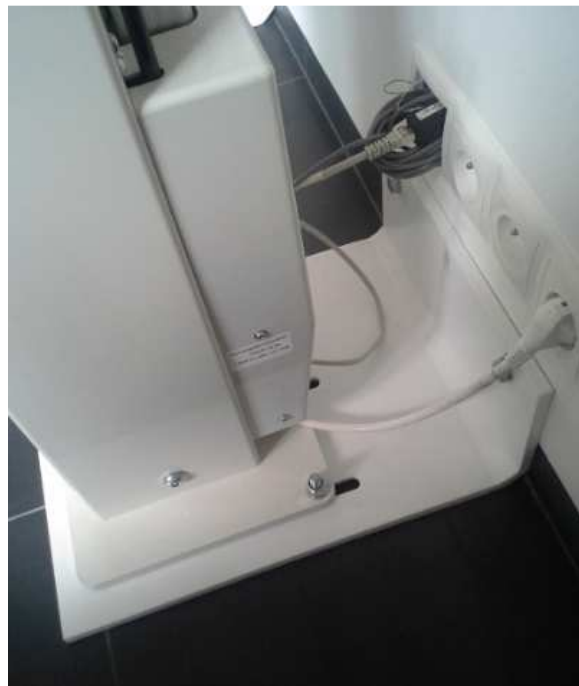
Rysunek 7 Zamontowanie aparatu na płycie montażowej
